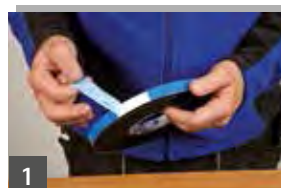
1 Schutzfolie entfernen Äußere Schutzfolie mit dem Cuttermesser auftrennen und abziehen.
