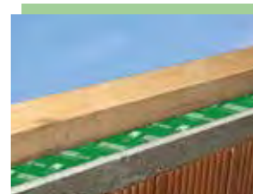
Einsatz unter Fußpfette Einsatz auch als Sperrschicht zum Schutz von Holzbauteilen, wie Schwellen oder Fußpfetten, gegen aufsteigende Feuchtigkeit aus Betonbauteilen (Bodenplatte, Ringanker etc.).
