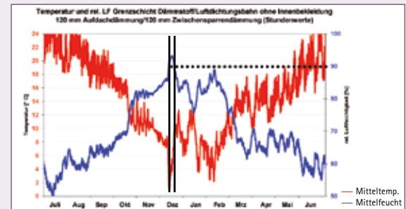
Abb. 14 + 15 Ergebnis für Fall 2: 1:1-Lösung – Luftdichtung mittig, Innenbekleidung mit Fugen
