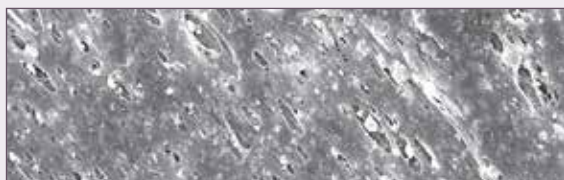
Abb. 19 Vergrößerung eines mikroporösen Funktionsfilmes
