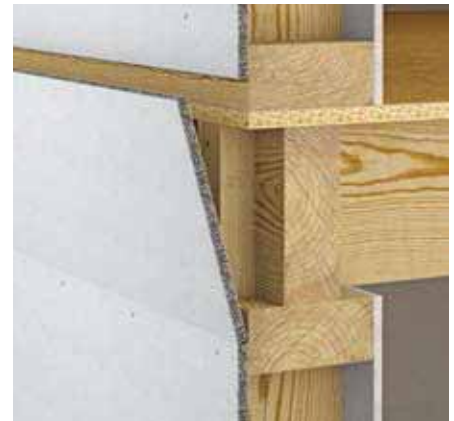
Bild 2: Montage des Plattenstreifens
