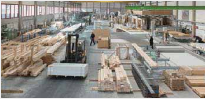
Fertigung von Holzbauelementen mit fermacell Gipsfaser-Platten
