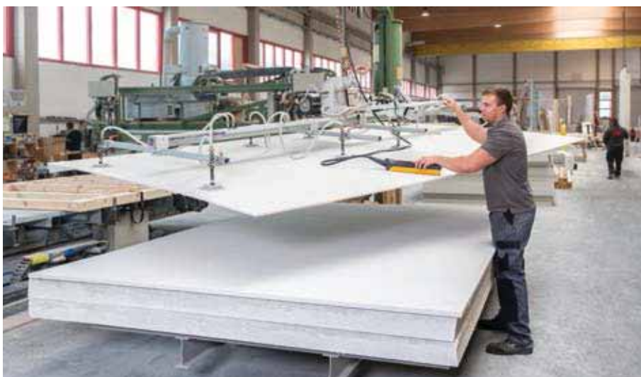
Transport von fermacell Gipsfaser-Platten mit einem Vakuumhebergerät
