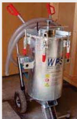
Mörtelpumpe zur Untermörtelung der Schwelle
