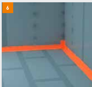
6 Bei Verwendung von Powerpanel TE im Bereich A0: fermacell Abdichtungssystem nur im Randbereich
