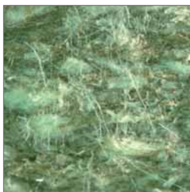
Abb. 10: Schimmelpilze auf PK 122 (H41), 40-fache Vergrößerung
