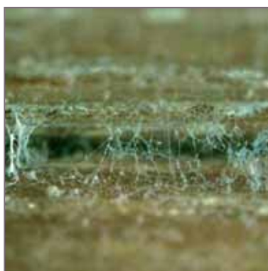
Abb. 9: Schimmelpilze auf PK 77 (Bangkirai), 50-fache Vergrößerung
